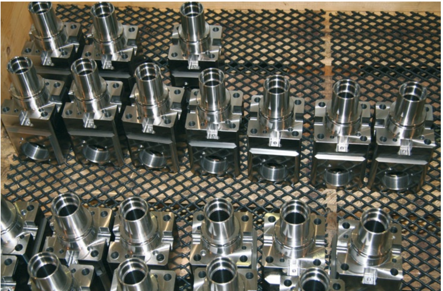
Werkzeugsystem Preci-Flex ist geeignet für den Einsatz von Spannzangen und/oder für viele verschiedene Werkzeugadapter
